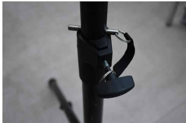
Jetzt kann die Box mit der in der Box integrierten Stativ Hülse auf das Standrohr gesteckt und ausgerichtet werden. Dabei die Box senkrecht halten.
