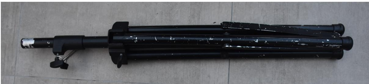
Hierzu die untere Knebelschraube lösen, aber nicht komplett herausdrehen. Dann die Stativfüße auf einen Abstand von etwas mehr als 1 Meter auseinanderziehen.
