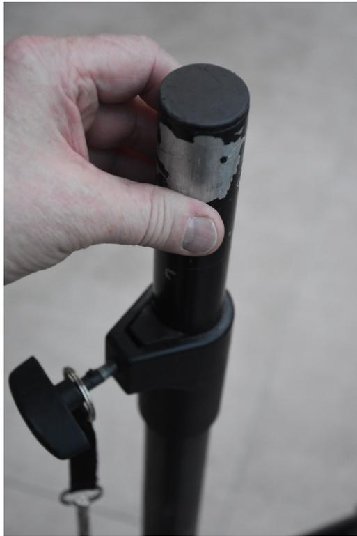
Nun darauf achten, das ein Loch oberhalb des unteren Standrohres zu sehen ist. Hier den angehängten Verriegelungsbolzen einschieben, bis er auf dem gegenüberliegenden Loch wieder herauschaut. Das Standrohr muss Senkrecht stehen. Den Verriegelungsbolzen mit dem oberen Standrohr nach unten schieben, bis der Bolzen auf dem unteren Standrohr aufliegt. Obere Knebelschraube leicht anziehen.
