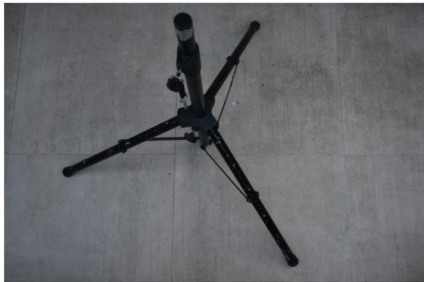
Untere Knebelschraube wieder leicht anziehen. Obere Knebelschraube lösen und Standrohr auf entsprechende Höhe herausziehen.
