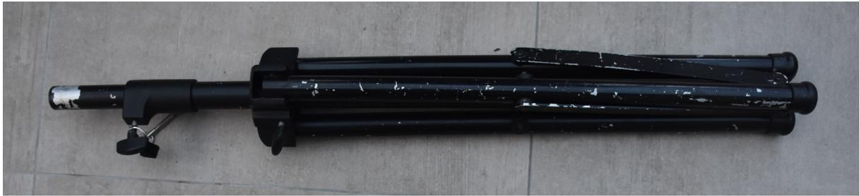
Hierzu die untere Knebelschraube lösen, aber nicht komplett herausdrehen. Dann die Stativfüße auf einen Abstand von etwas mehr als 1 Meter auseinanderziehen.
